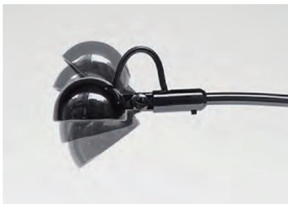
ランプは上下に 120°、左右に 90° まで角度調節が可能です。左右に首を振る場合はランプ根元のネジを付属の六角レンチで緩めてから調節してください。
