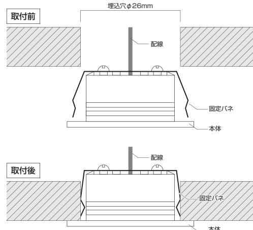
※ 取り付け可能な板厚は最薄3mmです。3mmより薄い場所には取り付けないでください。
